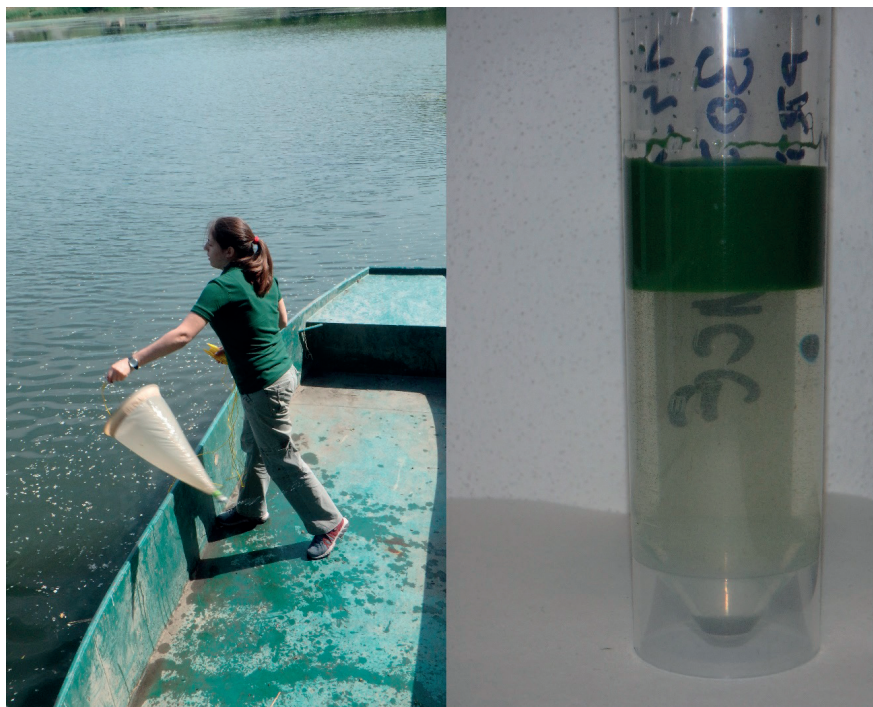
Obr. 16 Vlevo odběr vzorku pomocí vrhací planktonní sítky, vpravo vzorek odebraného fytoplanktonu s dominancí sinic (plavou u hladiny) ve vzorkovnici
