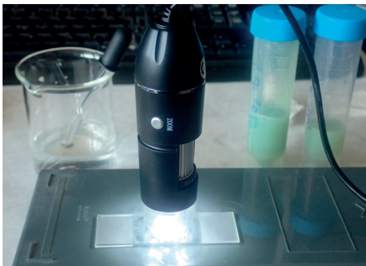
Obr. 18 Použití mikroskopu, vzorek mezi dvěma sklíčky, tmavá podložka
